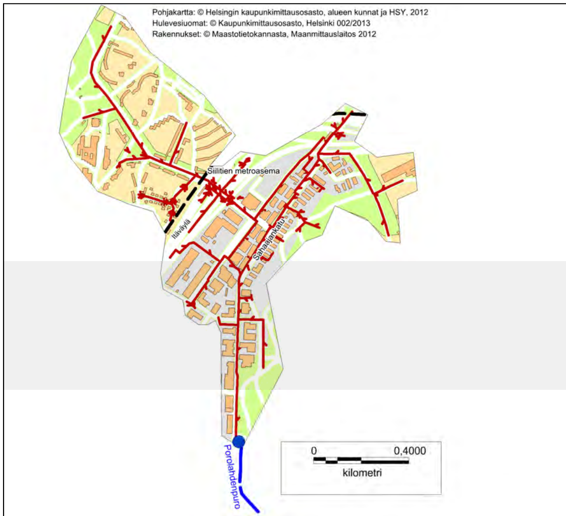
Kuva 20. Herttoniemen hulevesiviemärin valuma-alue ja näytteenottoaikka.
