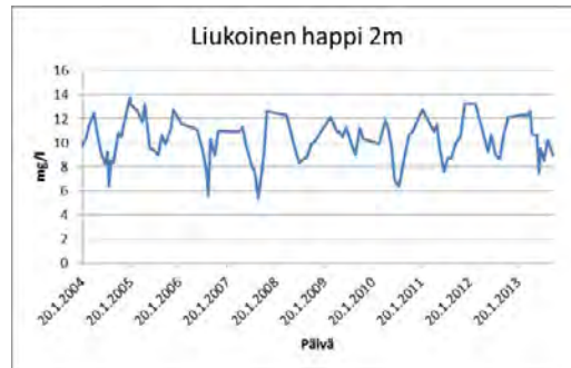
Kuva 3.21. Happitilanteessa näkyy vuodenaikainen vaihtelu. Täydellistä hapettomuutta ei ole enää ollut, mutta kesäkauden muutamat korkeat arvot viittaavat voimakkaaseen leväkukintaan pintavedessä.
