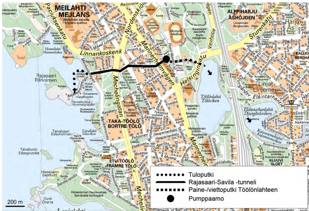
Kuva 2. Meriveden juoksutusreitti Humallahdelta Töölönlahteen. Kuva: Rakennusvirasto (2000).
