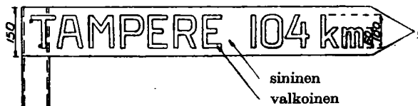
7. Taajaan rakennetuissa paikoissa käytettävä pääkulkusuuntaa osoittava kilpi.
