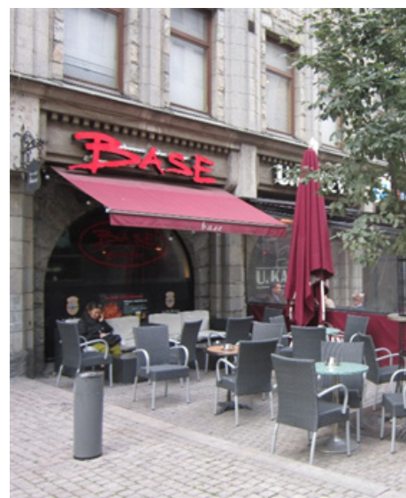
Korkeintaan 400mm korkean irtokirjainmainoksen asentaminen välittömästi huoneiston näyteikkunan yläpuolelle ei vaadi lupaa
