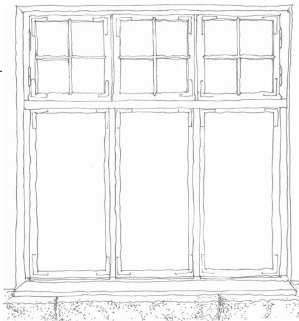
alla: Vaatimaton ikkunaesimerkki As Oy Olofsborgista. Ikkunoiden korkeus kasvoi jugendin aikakaudella. Ikkunan yläosa jaettiin pieniin ruutuihin usein paljon koristeellisemmin kuin esimerkissä. Ikkunan yläosaan saattoi liittyä myös suippokaari kuten As Oy Olofsborgin porttikäytävän oviaukoissa.
