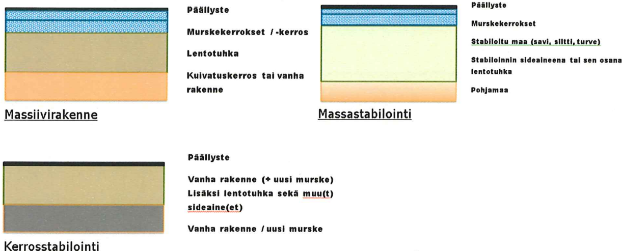
Kuva 9. Hyötykäyttösovellusten periaatekuvat massivirakenteesta, massastabiloinnista ja kerrosstabiloinnista.
