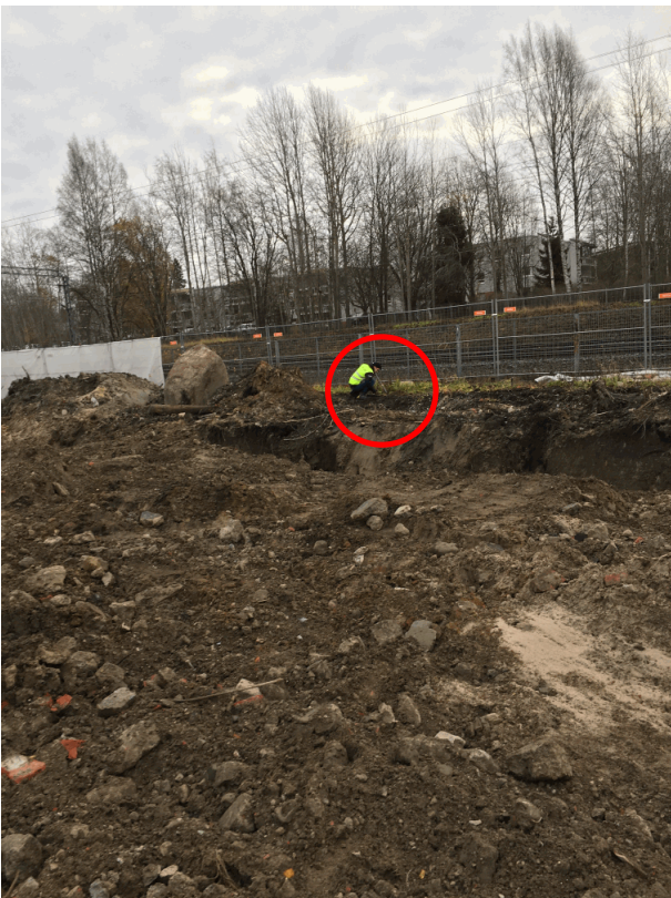
Mittauspiste 5. Sijainti purkutyömaan alueella radan puolella. Anturien kiinnitys maaruuvilla.
