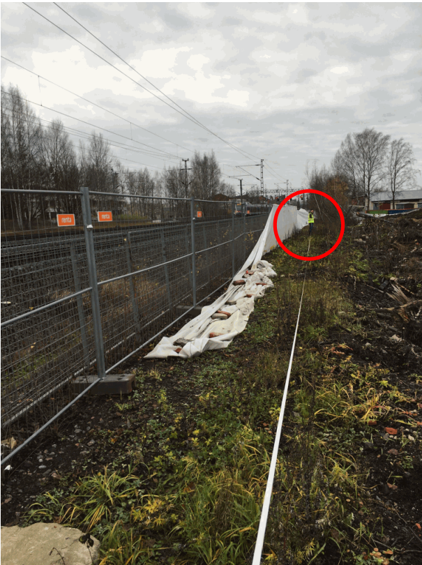
Mittauspiste 4. Sijainti purkutyömaan alueella radan puolella. Anturien kiinnitys maaruuvilla.
