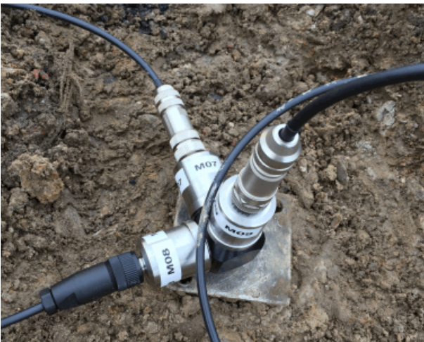
Mittauspisteet 6 ja 7. Anturien kiinnitys maaruuvilla.
