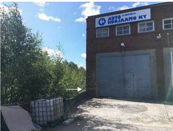
Mittauspiste 8. Sijainti vanhan pienteollisuusrakennuksen radanpuoleisella pohjoiskulmalla. Anturien kiinnitys liimaamalla rakennuksen betonisokkeliin.
