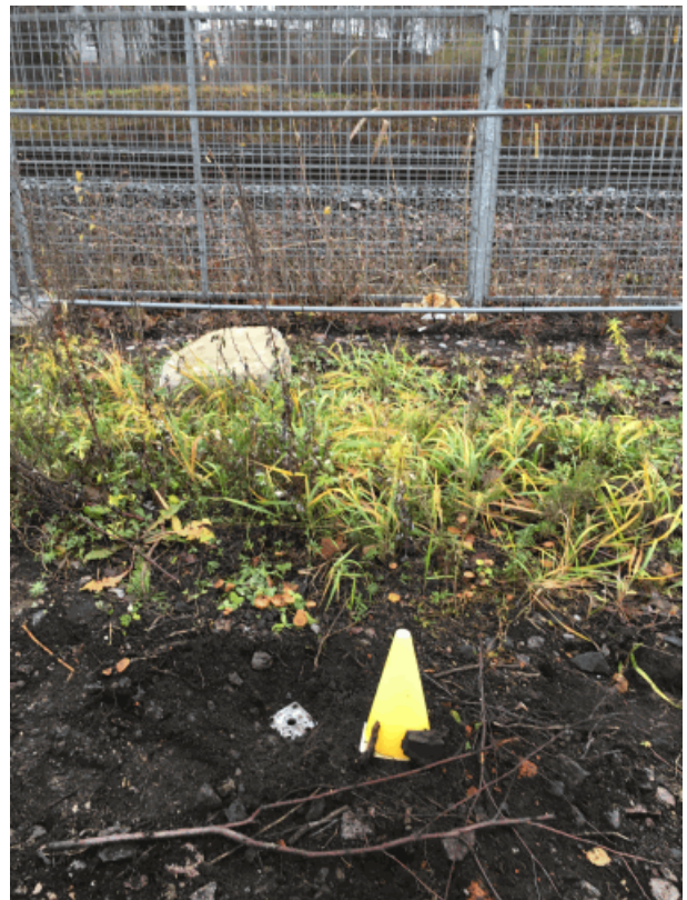
Mittauspiste 5. Sijainti purkutyömaan alueella radan puolella. Anturien kiinnitys maaruuvilla.
