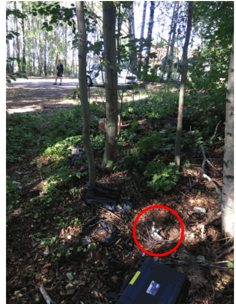
Mittauspiste 2. Sijainti purku-urakka-alueen raja-aidan vieressä, kuormalavojen varastoalueen pohjoisreunassa olevan maavallin takana. Anturien kiinnitys maaruuvin varaan.
