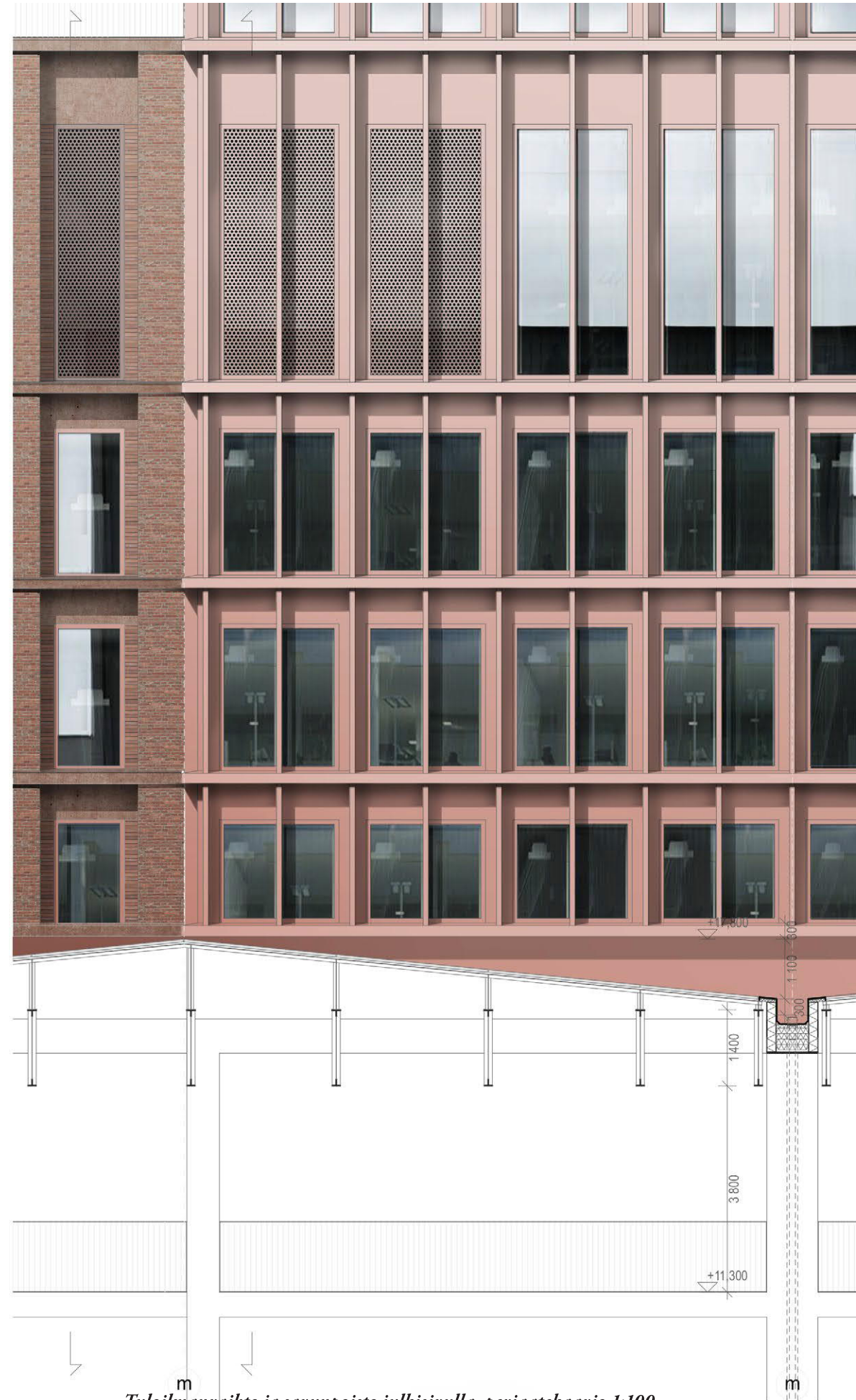
Tuloilmavaihto ja savunpoisto julkisivulla, periaatekaavio 1:100
