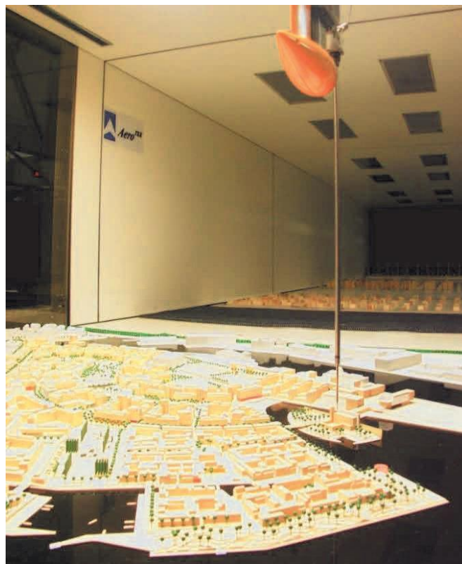
Kuva L2.1: Tuulitunnelikoe Jätkäsaaren osayleiskaavavaiheen kaupunkirakennemallin tuulisuuden selvittämiseksi (kuva WSP).
