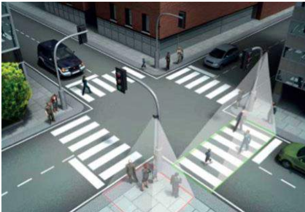
Periaatekuva älykkäästä jalankulkijoita havaitsevasta ilmaisinjärjestelmästä (lähde: vruits).
