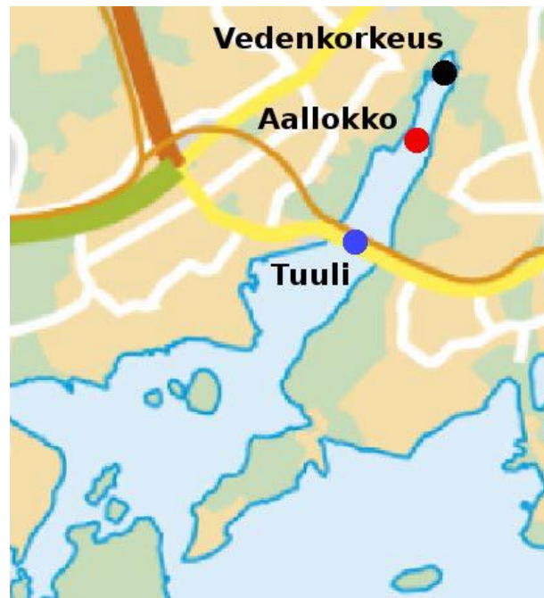
Kuva 84. Mittausasemat ja mittausajat Vartiokylänlahdella. Ylimpänä vedenkorkeusmittarin paikka, alimpana tuulimittarin paikka, sekä keskellä lahtea aaltopojun paikka.
