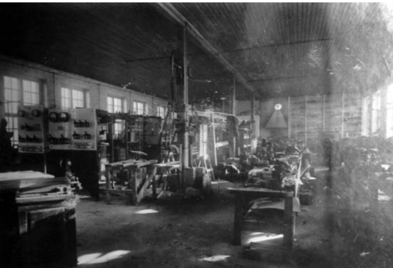
B-osan ylin kerros vuonna 1922. Se oli tuolloin Strömbergin sähkötauluja valmistava osasto. Huomaa puinen kattorakenne. TM
