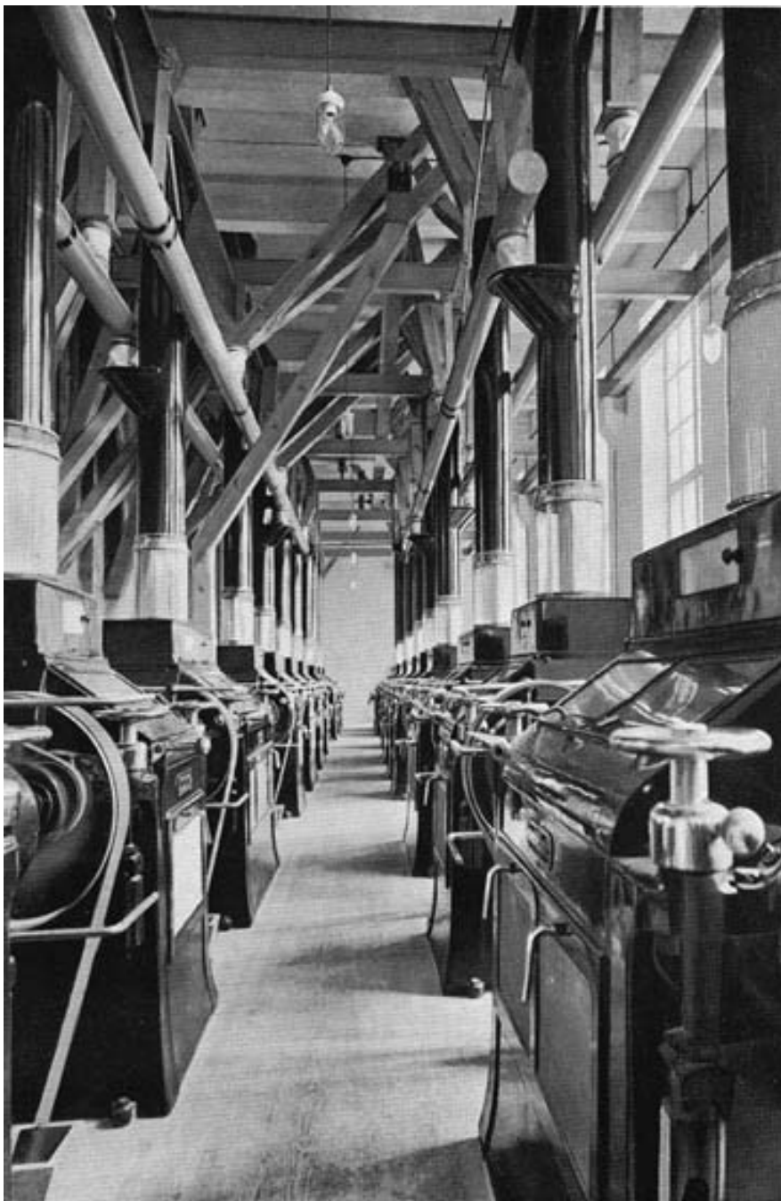
Valssituoleja B-osan toisessa kerroksessa vuonna 1935. HM
