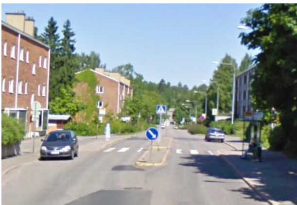
Kuva 35. Pysäkkityyppi, jolla pysähtyvä linja-auto pysäyttää oman ajosuuntansa liikenteen (2 toteutustapaa) (lähde: Vägverket 2004).
