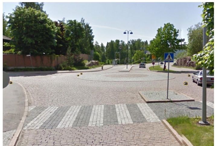
Kuva 11. Kokoojakadun kiertoliittymä Olarinkadun ja Komeetankadun risteyksessä. Liittymäalue on korotettu ja kivetty. (Kuva: Google Earth.)
