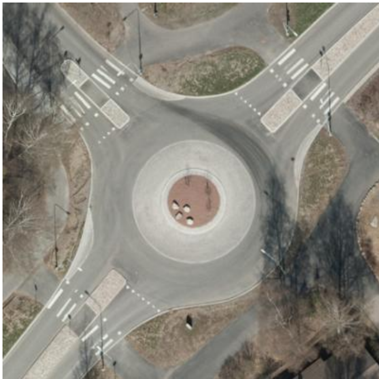
Kuva 5. Suutarilantien ja Riimusauvantien kiertoliittymä, jonka poistumishaaroissa on yliajettavat kiveykset kaventamassa ajotilaa. (Kuva: KMO/ ilmakuvat.)
