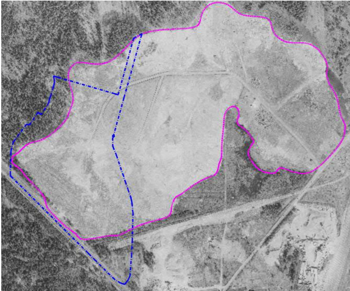
Kuva 3 Ilmakuva kaatopaikan alueelta vuodelta 1964. Sinisellä on rajattu suunnittelualue, punaisella ilmakuvien ja tutkimusten perusteella määritelty jätetäytön likimääräinen raja.
