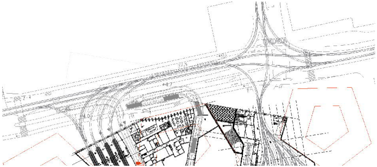
Kuva 9. Varikon edustalle katualueelle suunnitellut ratalinjaukset. Lukuisat vaihteet ja raideristeykset tuottavat merkittävää tärinä- ja runkomeluerätettä sekä ilmaäänenä leviävää ympäristömelua, jotka tulee huomioida radan perustamistavoissa sekä asuinrakennusten julkisivujen mitoituksessa.
