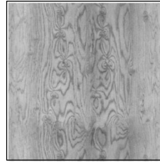
IKKUNOIDEN JA OVIENT PUUOSAT Kuusi, Suojaava kuultööljy, tummanharmaa, Osmo Color 905 Patina
