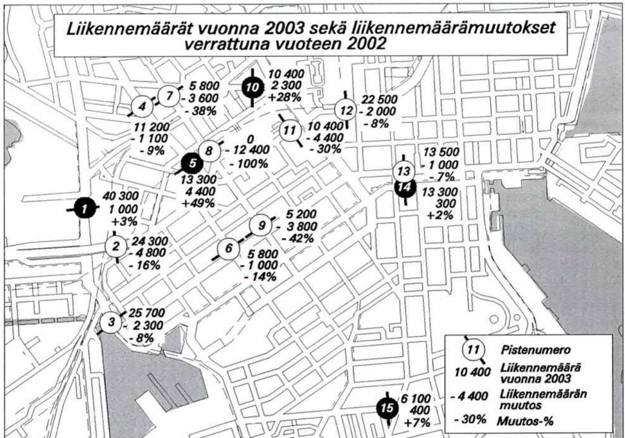
Kuva 2. Liikennemäärät (=automäärät) /vrk laskentapisteissä keväällä 2003 sekä muutokset vuoteen 2002 verrattuna.
