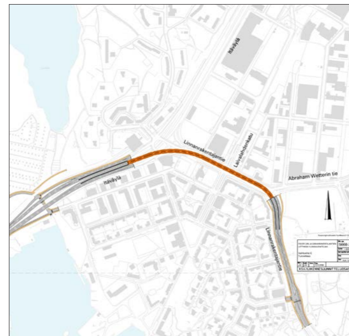
Kuva 8.2. Itäväylän ja Linnanrakentajantien tunnelit ja kaukalarakenteet.
