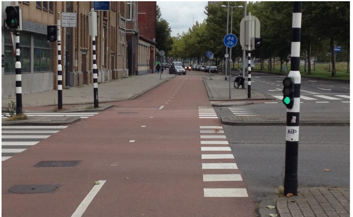
Kuva 20 Kun lähtökohtana on käsitellä pyörätien ja ajoradan välistä aluetta saarekkeena, pyörätien tasaus pysyy lähellä ajoradan pintaa ja luiskauksia ei käytännössä tarvita.
