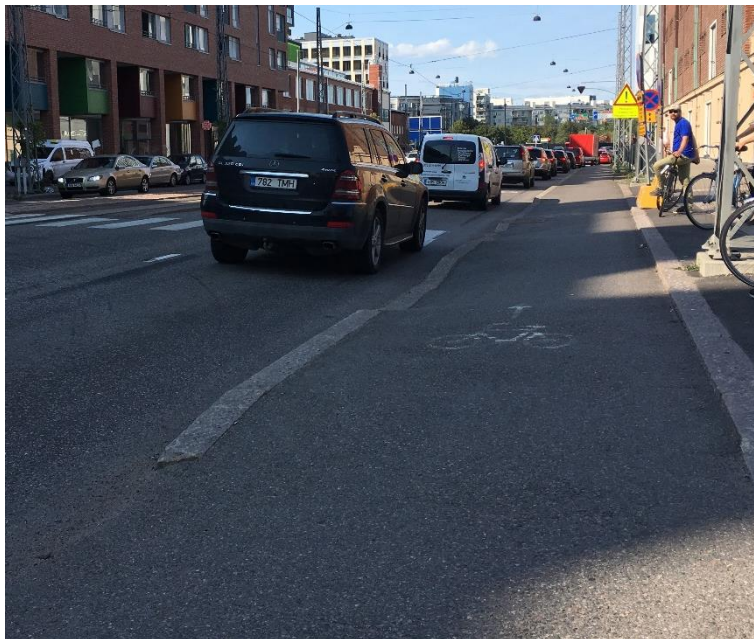
Kuva 34 Reunakiven korkoasema muuttuu turhan tiheään Tyynenmerenkadulla.
