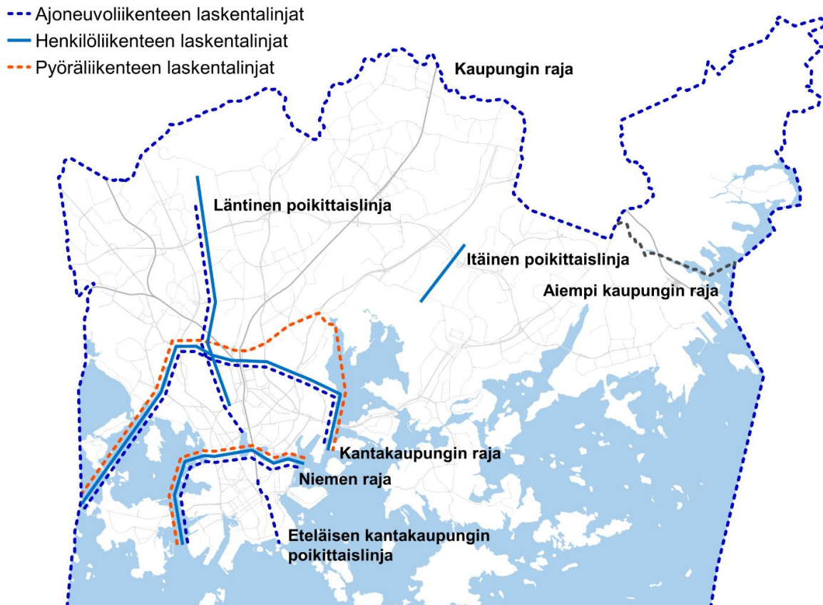
Kuva 1. Liikenteen kehityksen seurannassa käytettävät laskentalinjat.
