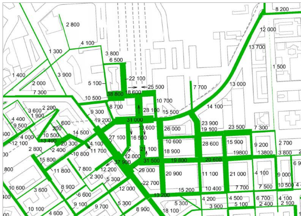
Kuva 2. Jalankulkijamääriä poikkileikkauksessa ajalta klo 06-20 (HKS 2014 & 2015)
