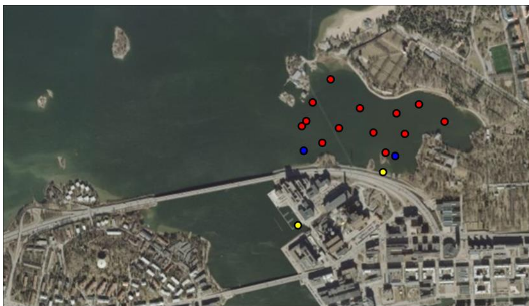
Kuva 9.4. Ilmakuva Lapinlahden alueesta sekä merilauhdeveden otto- ja purkukohdat (keltai-set pallot), mallinnusjakson aloitustilanteen kartoitusasemat (punaiset pallot) ja mallin-nus-jakson aikaisten lämpötilamittausasemien (siniset pallot) sijainnit.
