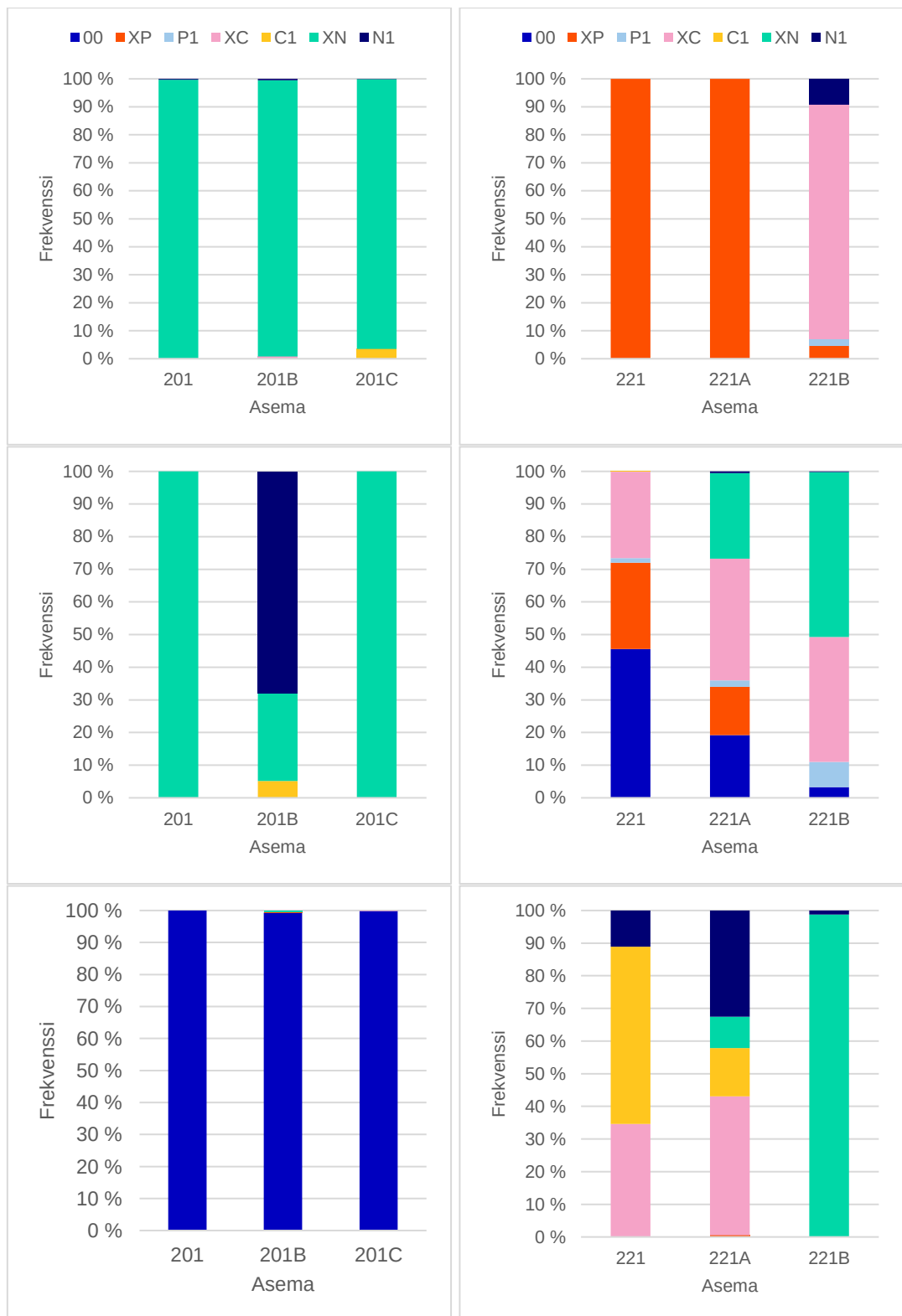
Kuva 5.23. Autonomisen ravinnerajoittuneisuusluokittelun tulokset esitettynä luokittelun todennäköisyytenä pohjautuen tulosten uudelleenotantamenetelmään.
