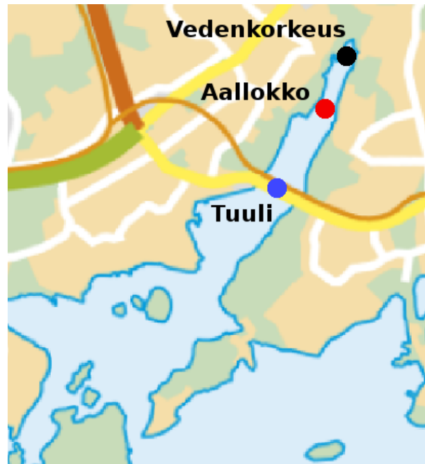
Kuva 84. Mittausasemat ja mittausajat Vartiokylänlahdella. Ylimpänä vedenkorkeusmittarin paikka, alimpana tuulimittarin paikka, sekä keskellä lahtea aaltopoijun paikka.
