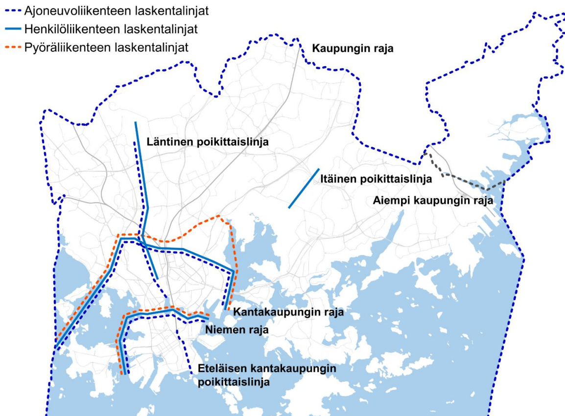
Kuva 1. Liikenteen kehityksen seurannassa käytettävät laskentalinjat.
