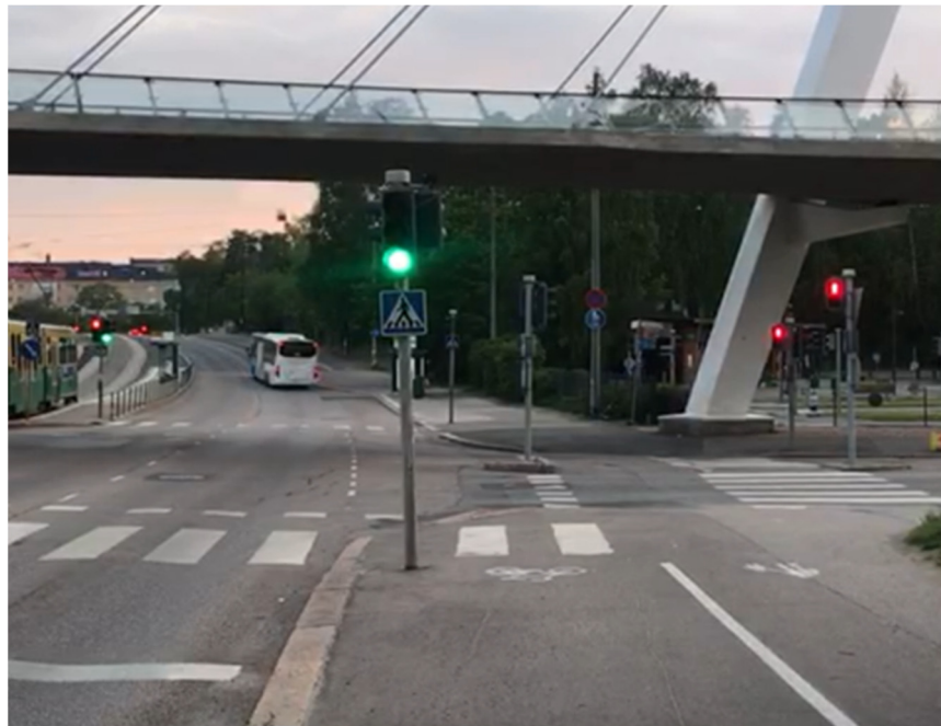
Kuva 15 Nordenskiöldinkadulla raitiovaunu (vasemmalla) pyytää vihreän pidennystä, missä pyyntö koskee vain raitiovaunuopastimia ja ajoneuvo-opastimia, mutta ei jalankulkuopastimia, jolloin pyöräliikenteen viivytykset kasvavat. (oma kuva)
