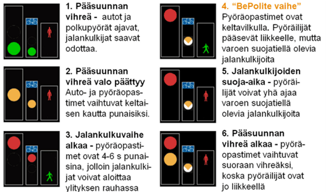
Kuva 4 Pyöräopastimen BePolite-valo-ohjauksen toimintaperiaatteet. (Sane 2014e)
