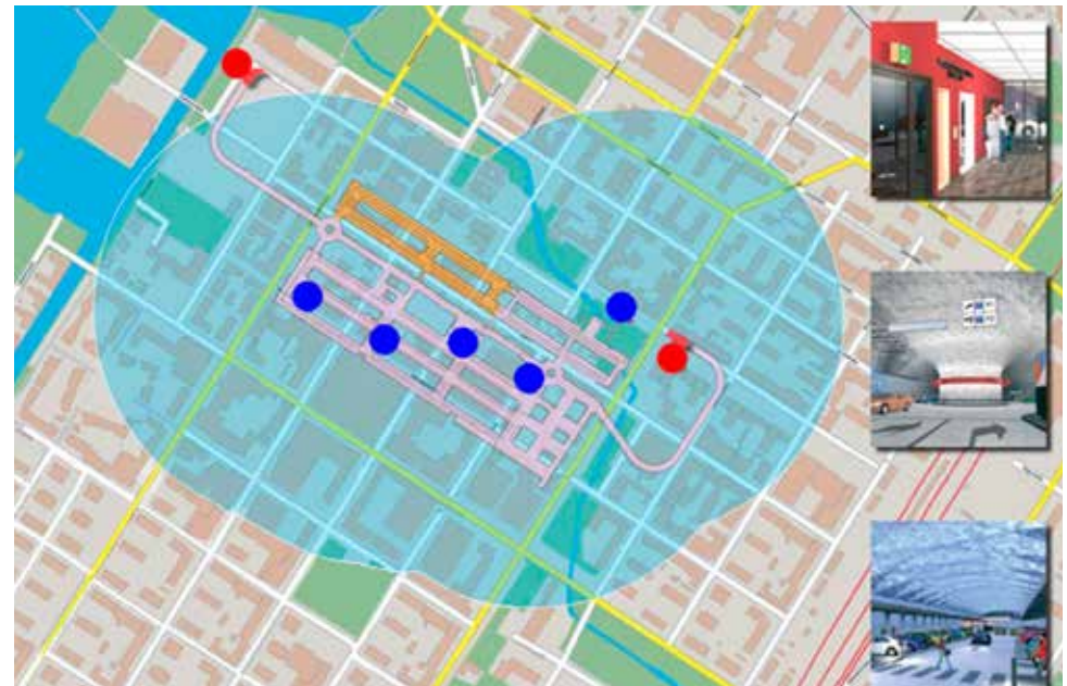
Fig. 14. Kivisydän (Stoneheart) The underground parking cavern in Oulu ● lift ● car access (Image: City of Oulu and Oulun Pysäköinti Oy)
