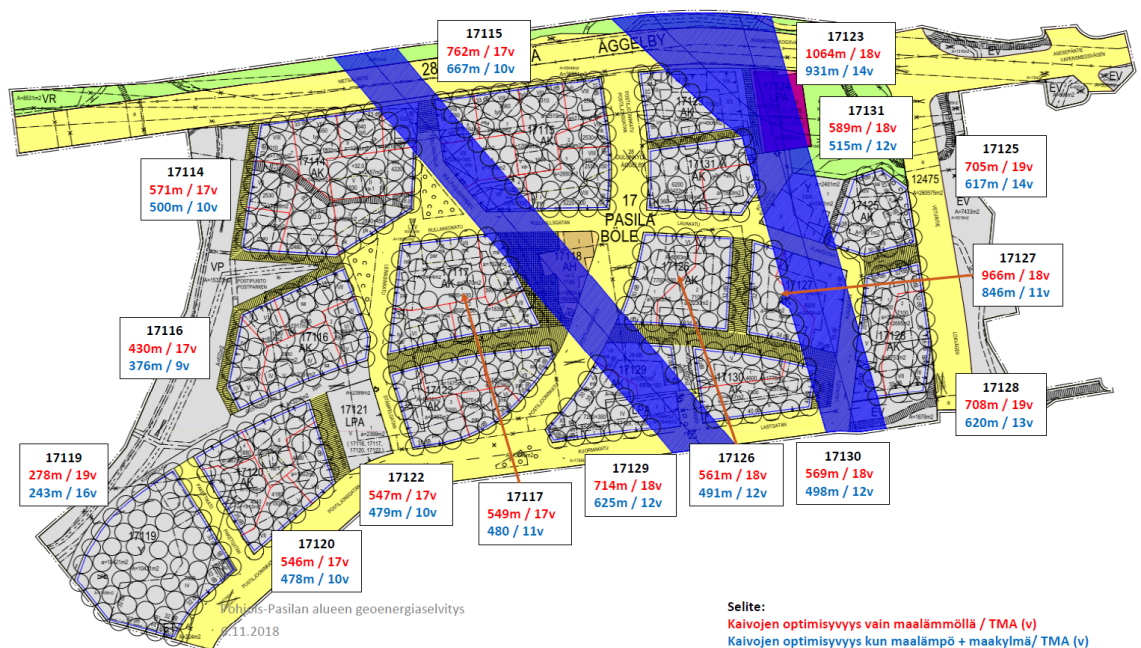
Kuva 7. Kaivosyvyystarkastelu, jolloin energiapeitoksi asetettiin asuinkortteleissa 93 % ja koulukortteleissa 83 %. Punaisella luvulla on merkitty kaivosyvyyttä silloin, kun käytössä on vain maalämpö. Sinisellä luvulla on puolestaan merkitty kaivosyvyyttä silloin, kun käytössä on sekä maalämpö että jähdytys. TMA on energiajärjestelmän takaisinmaksuaika vuosissa. Laskenta tehtiin COMSOL Multiphysics® v5.3 –ohjelmistolla ja mitoitusajana on käytetty 40 vuotta. [5]
