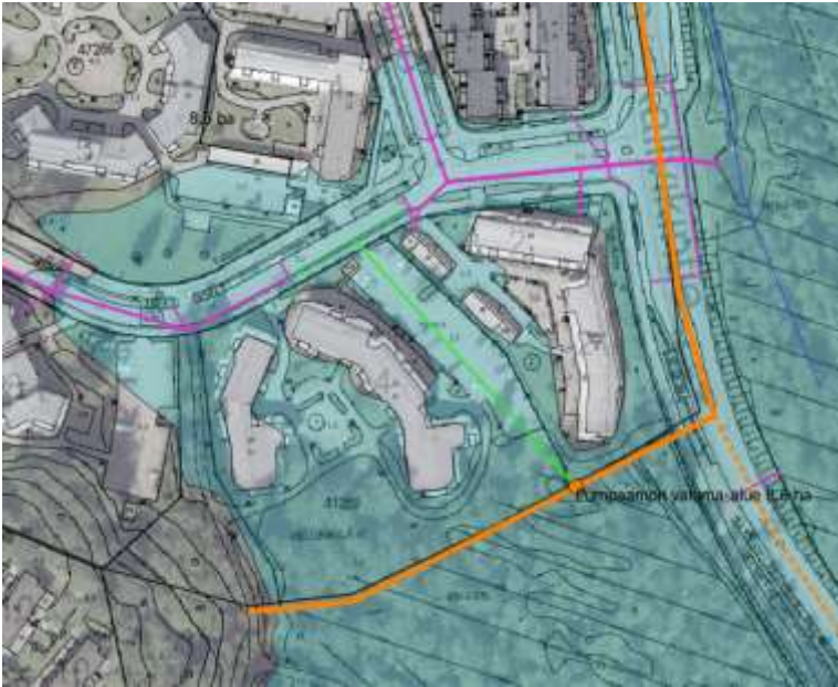
Kuva 73. Tarkastellulla +2,80 m meritulvalla Fallpakankujan kolme kerrostaloa (ml. lastenkoti) jäisivät tulvan saartamiksi.
