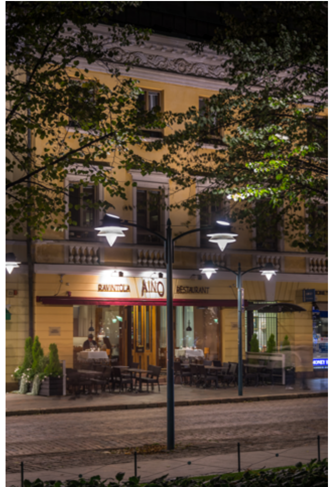
Kuva 127. Katuvalaistus on toteutettu 4,5 metriä korkeilla, vihreäksi maalatuilla pylväillä, joissa on kaksi valaisinta. Valokuva Juhana Konttinen. Helsingin kaupunki.
