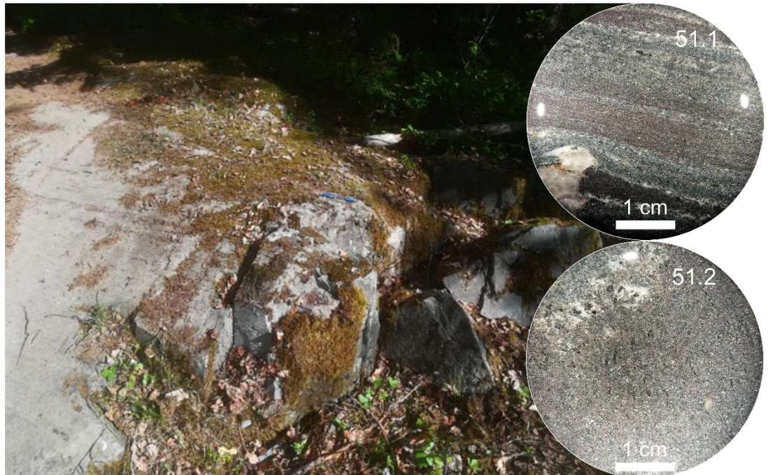
Kuva 52. TIN$-2018-51. Pieni kalliopaljastuma Sundbergissa (P = 6680182 m, I = 25509300 m). Näyte on raitaisesta biotiitti-plagioklaasigneissistä. Näytteestä tehtiin kaksi näytekiekkoa (uppokuvat) kiven termisen anisotropian selvittämiseksi (kts. liite 1). Uppokuva on märästä näytekiekosta. Uppokuvissa valotusta on hieman nostettu, jotta kiven teksturi näkyisi selkeämmin.
