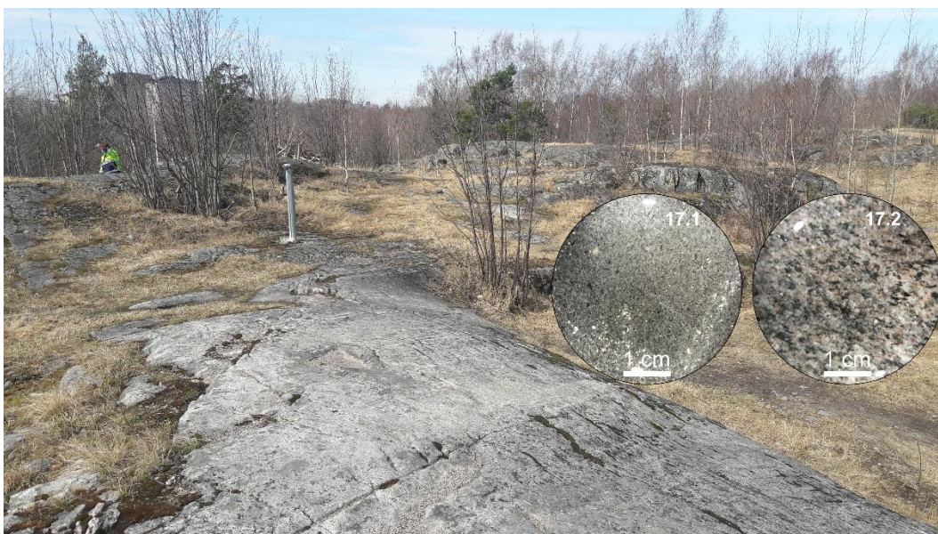
Kuva 34. TIN$-2018-17. Laaja tonaliittipaljastuma Kumpulassa (P = 6676835 m, I = 25497728 m). Kohde on kivilajikartan amfiboliittialueella. Siksi kohteelta mitattiin 2 näytettä (uppokuvat): 17.1 amfiboliitti ja 17.2 tonaliitti. Uppokuvat ovat märistä näytekiekoista. Uppokuvissa valotusta on hieman nostettu, jotta kiven teksturi näkyisi selkeämmin. Amfiboliittia on vain noin 10 % paljastumasta.
