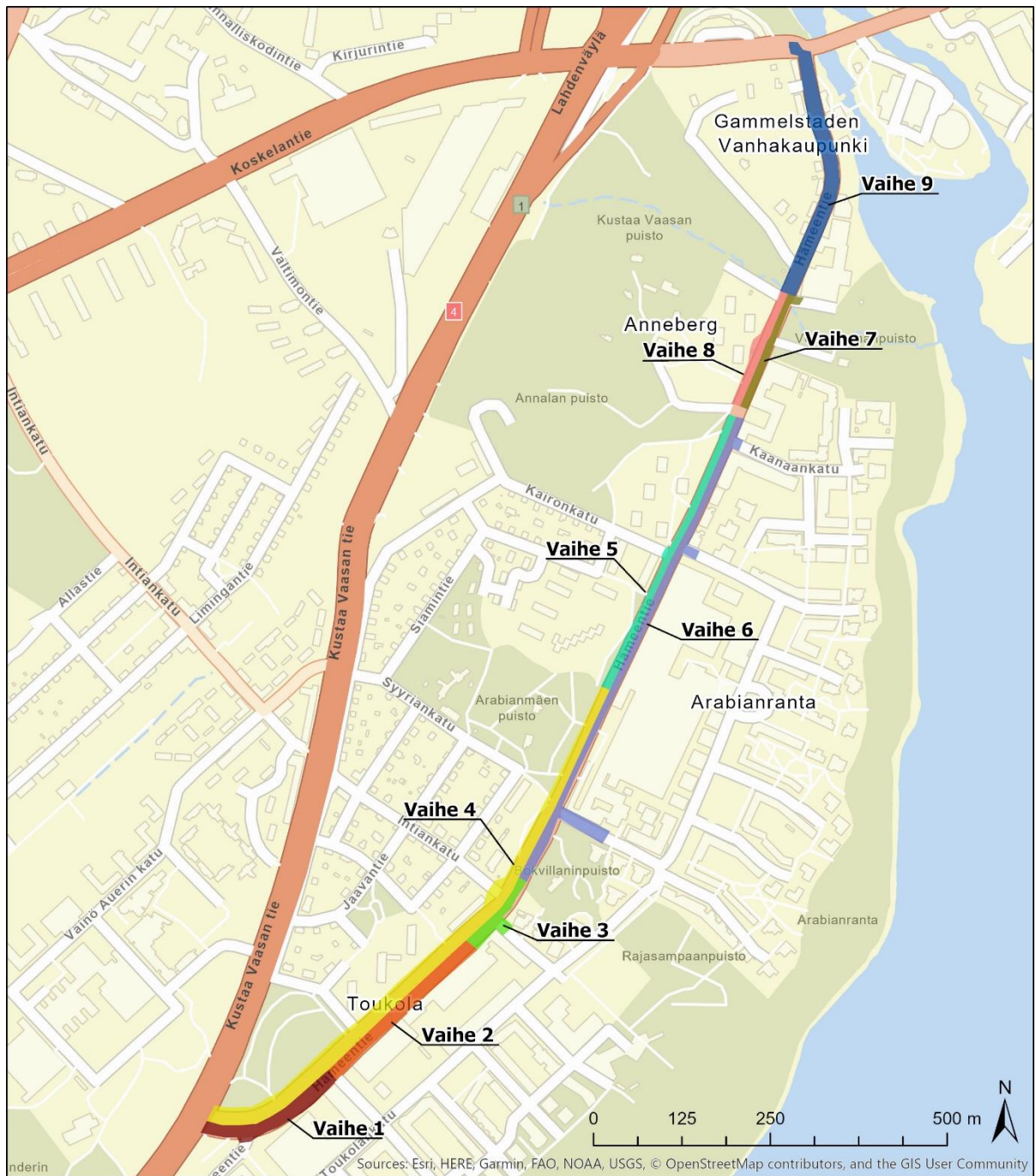
Kuva 16. Hämeentien katusaneeraushankkeen työnaikaisten liikennejärjestelyiden vaiheistussuunnitelma
