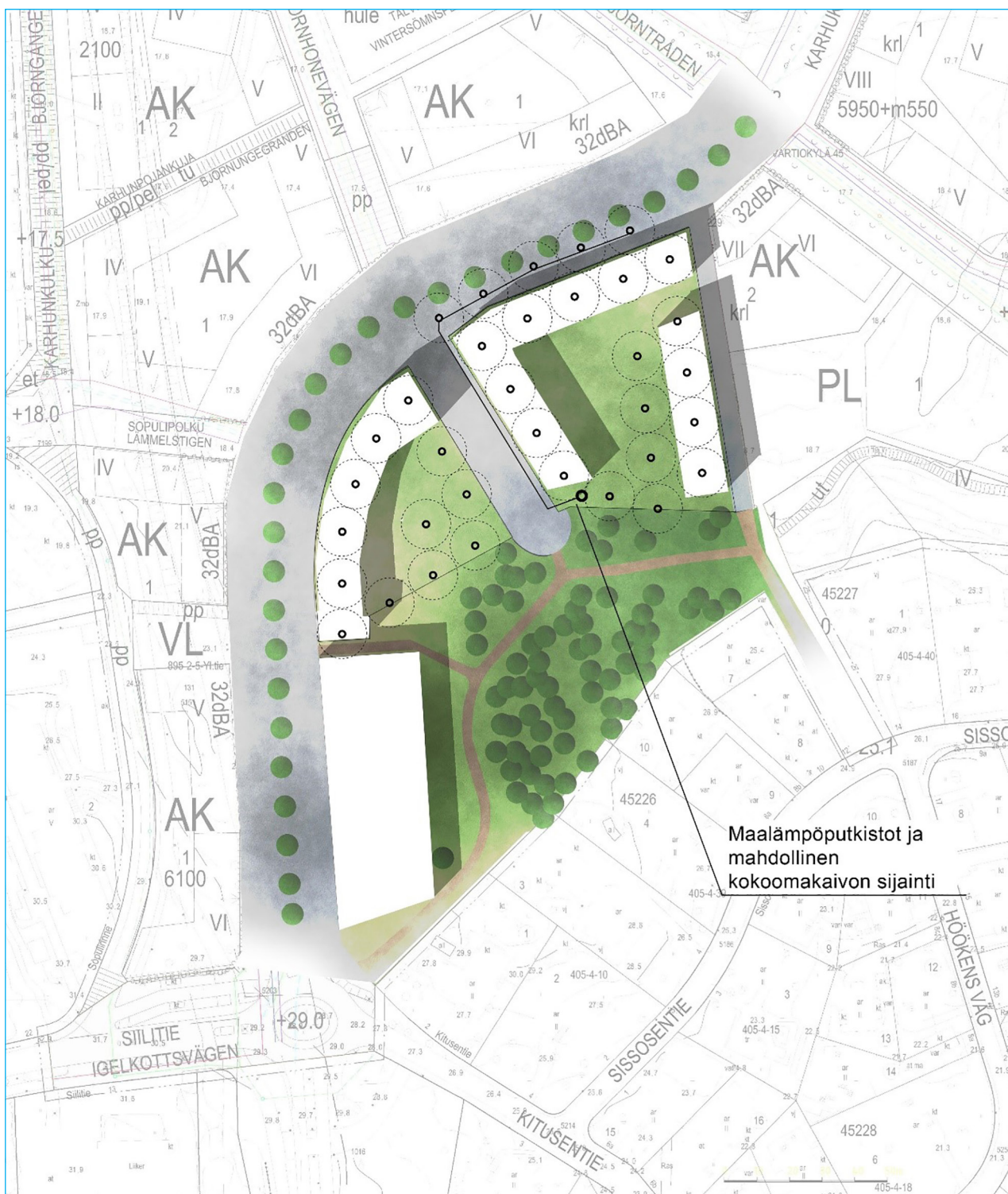
Kuva 9 Maalämpöjärjestelmän osien sijoittaminen katualueelle
