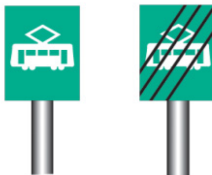
Kuva 8: Tasoristeyksettömän rata-alueen alkamismerkki (vasen) ja päättymismerkki (oikea)
