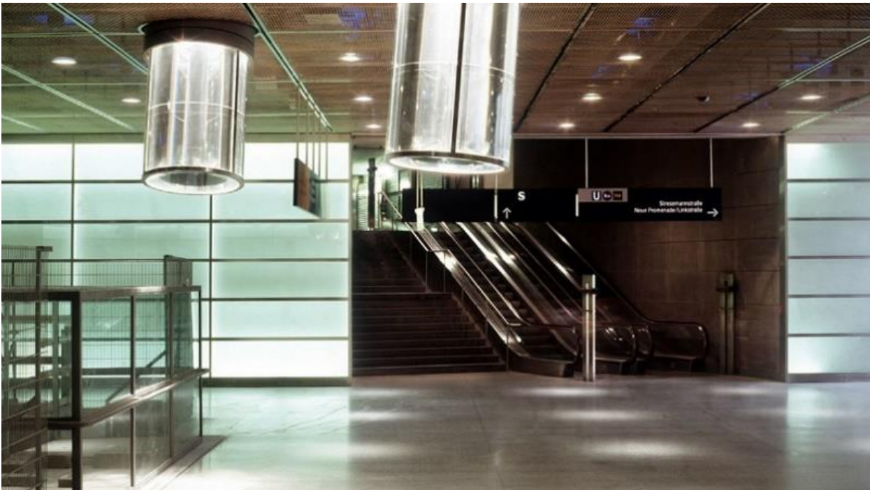
Kuva 42. Kolme "valoputkea" taittavat ja tuovat luonnonvaloa Potsdamer Platzin maanalaiselle asemalle. Kuvalähde: https://www.krapfag.ch/en/reference-projects/metal-construction/light-pipes-berlin-potsdamer-platz/
