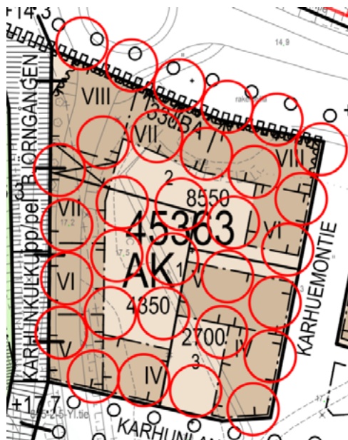
Kuva 23. Maalämpökaivojen sijoittamisen hahmotelma korttelissa 45363.
