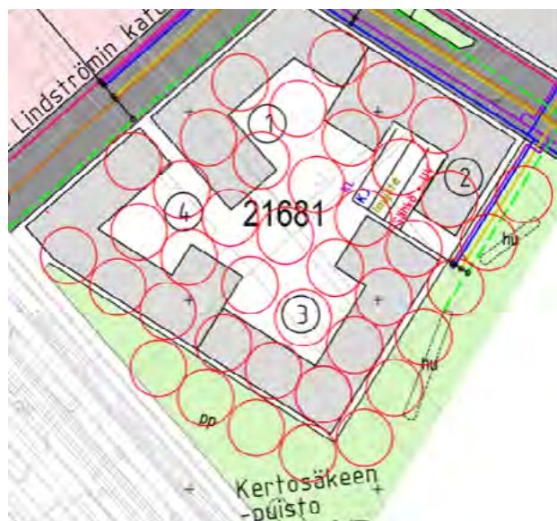
Kuva 7. Maalämpökaivojen sijoittamisen hahmotelma korttelissa 21681.
