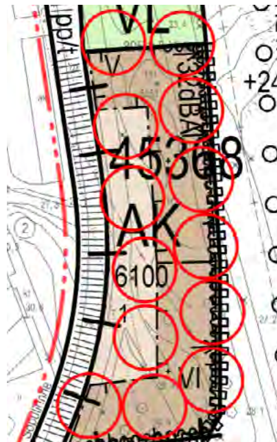
Kuva 17. Maalämpökaivojen sijoittamisen hahmotelma korttelissa 45368.
