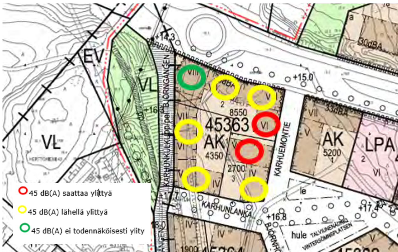
Kuva 37. Karhukallion korttelin 45363 katolle sijoitettavien lämmönkeräinten mahdollisten sijaintien toteutuskelpoisuus esitetty värillisillä ympyröillä.
