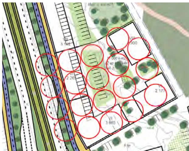
Kuva 27. Maalämpökaivojen sijoittamisen hahmotelma korttelissa 1.
