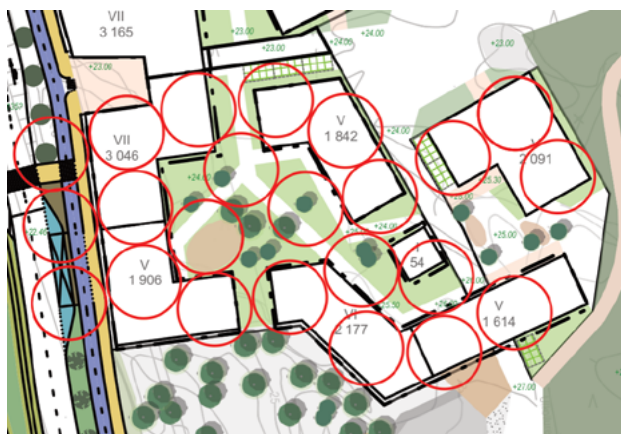
Kuva 30. Maalämpökaivojen sijoittamisen hahmotelma korttelissa 2.
