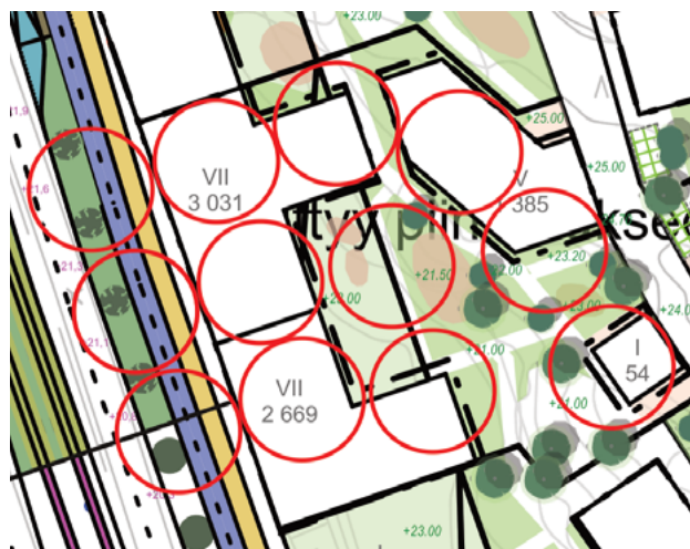
Kuva 33. Maalämpökaivojen sijoittamisen hahmotelma korttelissa 3.
