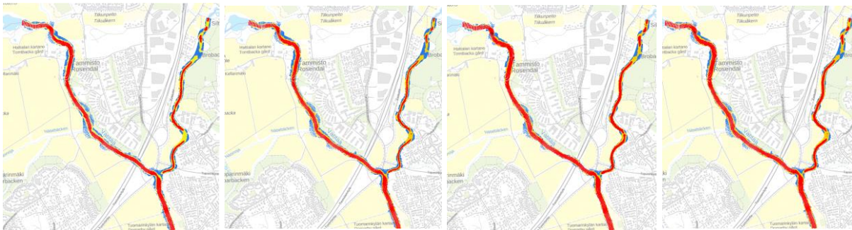
Kuva 38 Yläosan virtausnopeudet HQ-tilanteessa. Skenaariot vasemmalta oikealle: 1,2,3 ja 4. Siniset pisteet: kerrostumialue. Keltaiset pisteet: akkumulaatioalue. Punaiset pisteet: eroosioalue. Viininpunaiset pisteet: eroosioalue, virtausnopeus yli 1 m/s.
