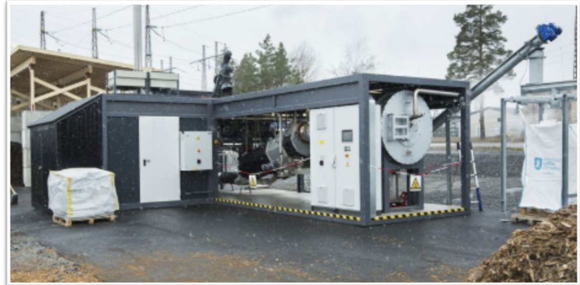
Kuvan saksalainen Pyreg pyrolyysilaitos on käytössä Tukholmassa. Laitos tuottaa biohiiltä noin 300 t/a ja käyttää raaka-ainetta noin 1 200 t/a. Investointi noin 400 000 eur.
