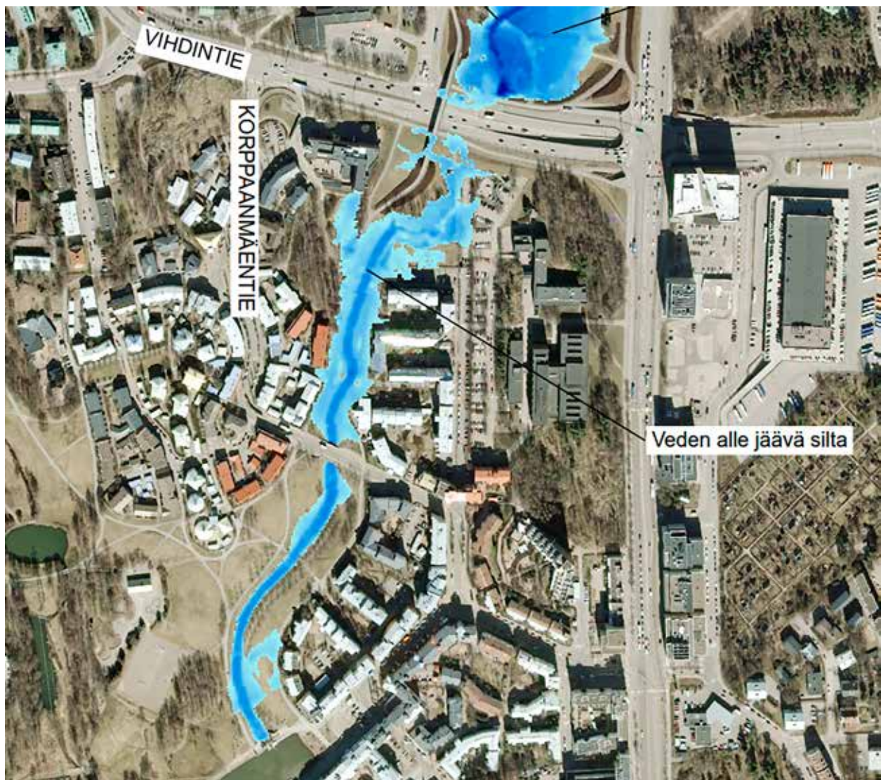
Kuva 4. Nykytilanteessa kerran 50 vuodessa toistuvan sateen aiheuttama tulva-alue tarkastelualueella Vihdintien eteläpuolella (Helsingin kaupungin rakennusvirasto, Haaganpuron valuma-alueen hulevesiselvitys, Ramboll, 2016).
