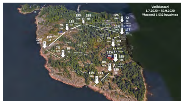
Kuva 5. Kävijäseuranta Bluetooth-teknologialla. Numerot osoittavat Bluetooth-tukiasemien sijaintia (nuolet), havaintojen kokonaismäärää (suuri kokonaisluku) ja prosenttiosuutta kaikista havainnoista.
