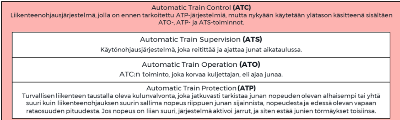
Kuva 2 Havainnollistava diagrammi automaatiojärjestelmien suhteista toisiinsa.
