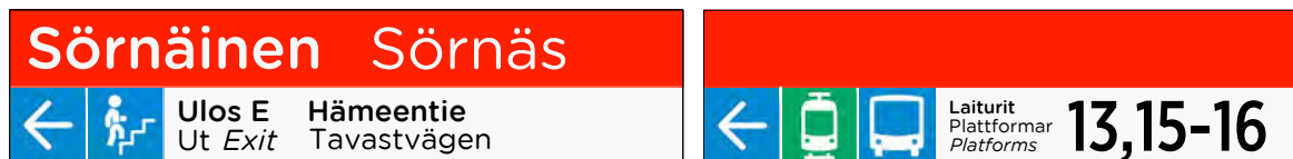
Kuva 22. Opastaminen vasemmalle. Vaihtoyhteyksien laiturinumerointi -elementti erillisessä opasteessa uloskäynnin opasteen välittömässä läheisyydessä.
