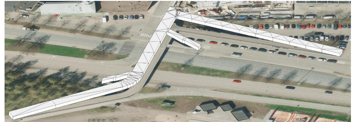
Kuva 32 Sillan kannen ja alapohjan etäisyydeksi valittiin kaksi metriä, jotta sillat näkyisivät paremmin mallissa.
