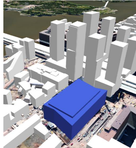
Kuva 76 LoD2-tasoinen CityGML-rakennus tuotettuna CAD-aineistosta.
