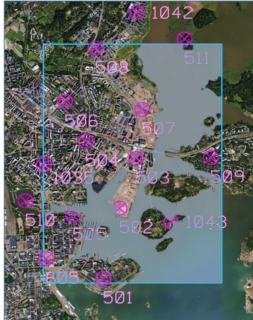
Kuva 6 Kalasataman testialueen 15 tukipistettä ja digitoitu vesialue.
