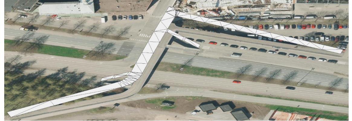
Kuva 31 Lähtötilanne: Vektoroitu silta DGN-formaatissa (Kaikukadun kevyen liikenteen silta, Hakaniemi).
