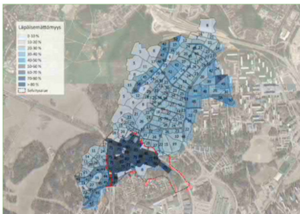
Kuva 1. Mallinnetun alueen jako osavaluma-alueisiin sekä läpäisemättömän pinnan osuudet osavaluma-alueittain.
