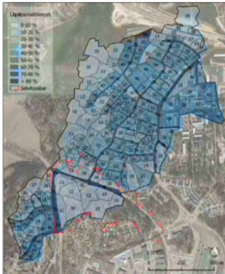
Kuva 17. Osavaluma alueiden läpäisemättömyysprosentit nykytilanteessa.
