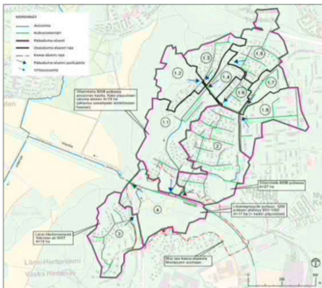
Kuva 6. Kaava-alueen kautta Viikintien varren uomaan purkava valuma-alue jaettuna osa-alueisiin.
