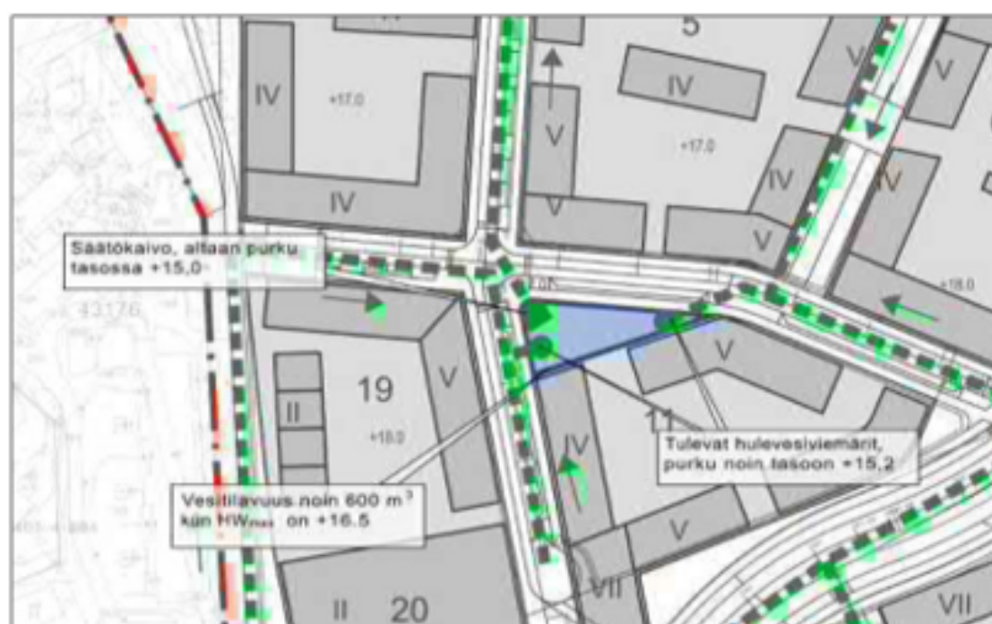
Kuva 24. Kaava-alueen sisäinen hulevesien viivytys
