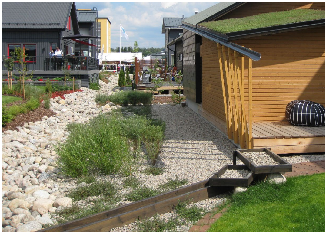
Kuva 8. Esimerkki hulevesien hallintajärjestelyistä Jyväskylän asuntomessualueelta.
