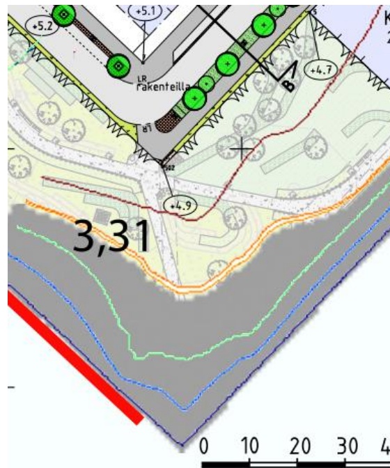
Kuva 9 Neptunuksen puiston lounaisrannalla punaisella merkityllä alueelle ei ole tarpeen tehdä vedenalaista loivennettua luiskaa kaltevuuteen 1:3,7, vaan tavanomainen lohkaireluiska 1:1,5 riittää.
