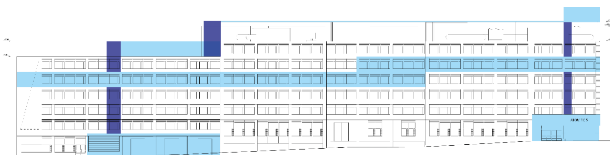
Kuva 24: Vaihtoehto 3: rakennuksen poikkileikkaus, tilajärjestelyt ja hissiyhteydet
