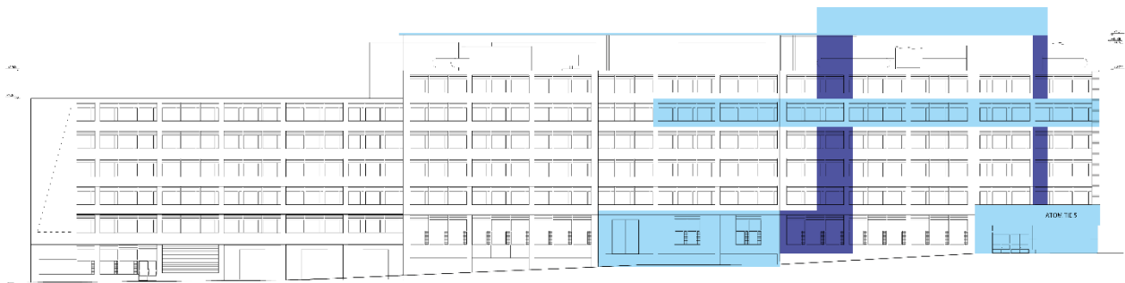
Kuva 22: Vaihtoehto 1: rakennuksen poikkileikkaus, tilajärjestelyt ja hissiyhteydet
