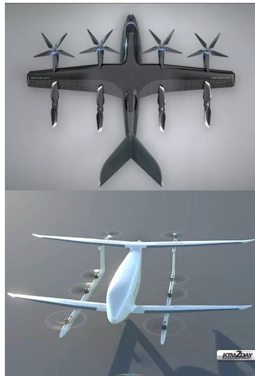
Kuva 15: Vertiportin mitoituksessa tarkastellut eVTOL-ilma-alukset: Midnight Archer ja Nuuva V300. (Vertical Aerospace, n.d.; Pipistrel, n.d.)
