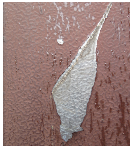
Robertson-versacor PVD-pinnoitettua peltiä. Alla tuntemattomasta syystä muodostunut vauriokohta, jonka alta paljastuu ehjä galvanointi.
