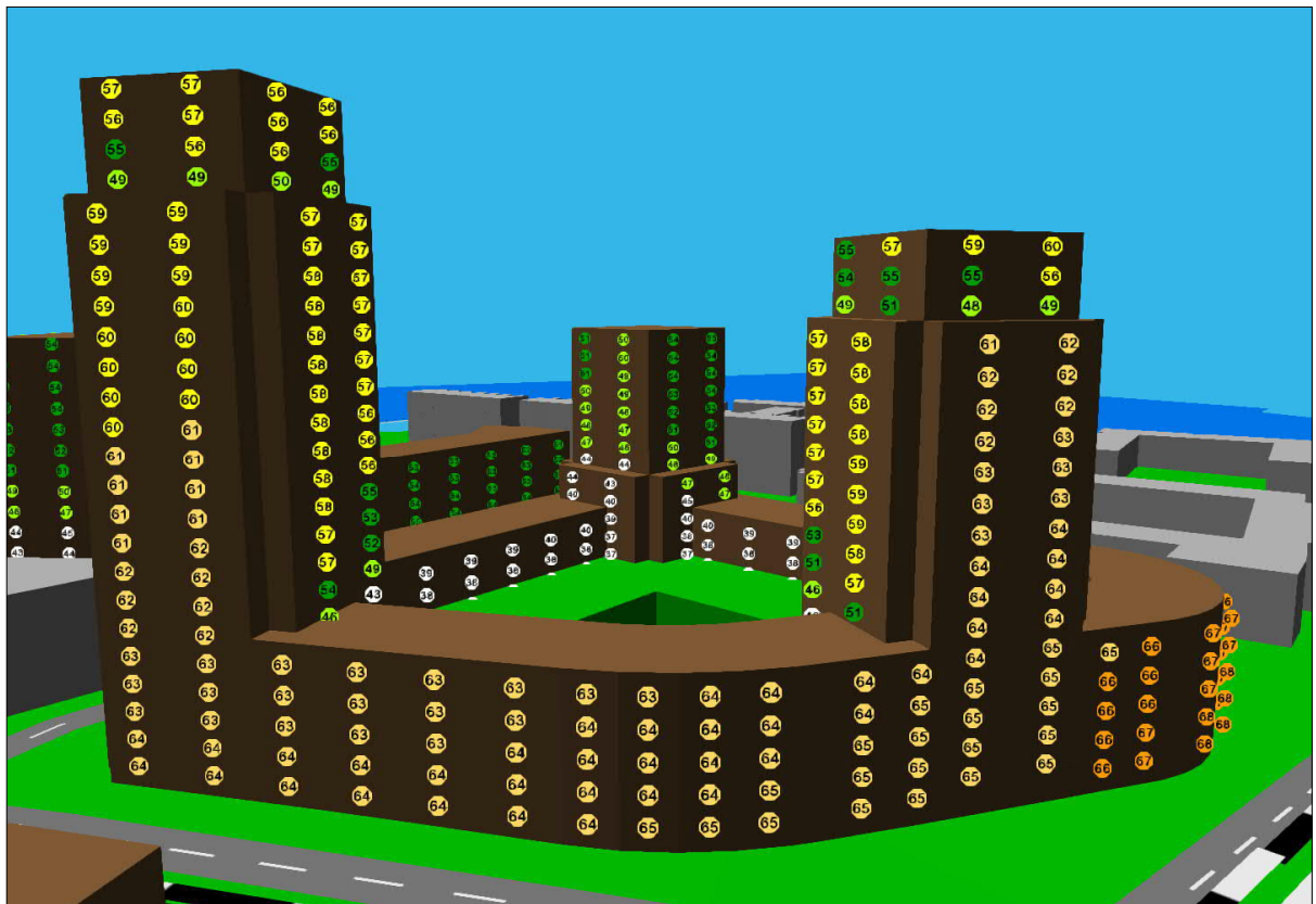
Kuva 2. Jätkäsaaren keskuskortteliin julkisivuille kohdistuvat tie- ja raitiovaunuliikenteen aiheuttamat keskiäänitasot. Näkymä idästä.
